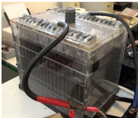
Σχ. 2.14 Μπαταρία οξέος μόλυβδου με διαφανές περίβλημα.
