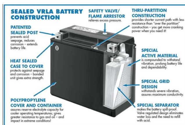
Σχ.2.13. Τα έξη στοιχεία μιας μπαταρίας μολύβδου-οξέος. .
