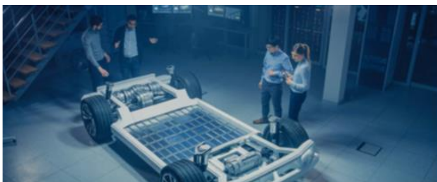
Σχ.4.11. Κελιά μπαταριών σε ηλεκτρικό αυτοκίνητο. (21)
