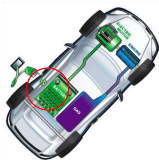
Σχ.5.2. Υβριδικό ηλεκτρικό όχημα με τροφοδοσία από σταθερή πηγή ενέργειας (28)
