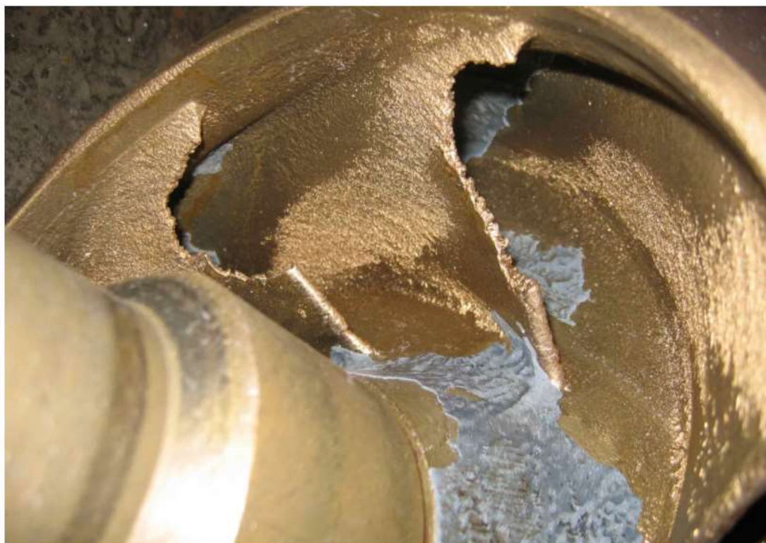
Εικόνα 4-4 Το φαινόμενο της σπηλαίωσης σε μια φυγοκεντρική αντλία
