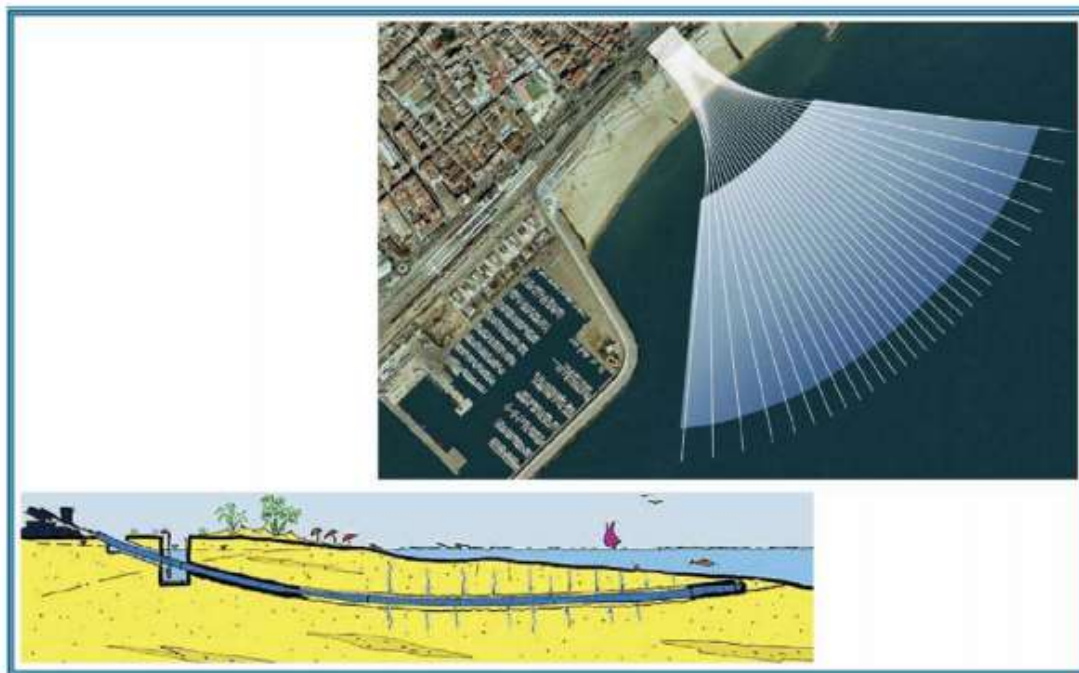
Εικόνα 2-1 Τοποθέτηση οριζόντιου διάτρητου σωλήνα αναρρόφησης
