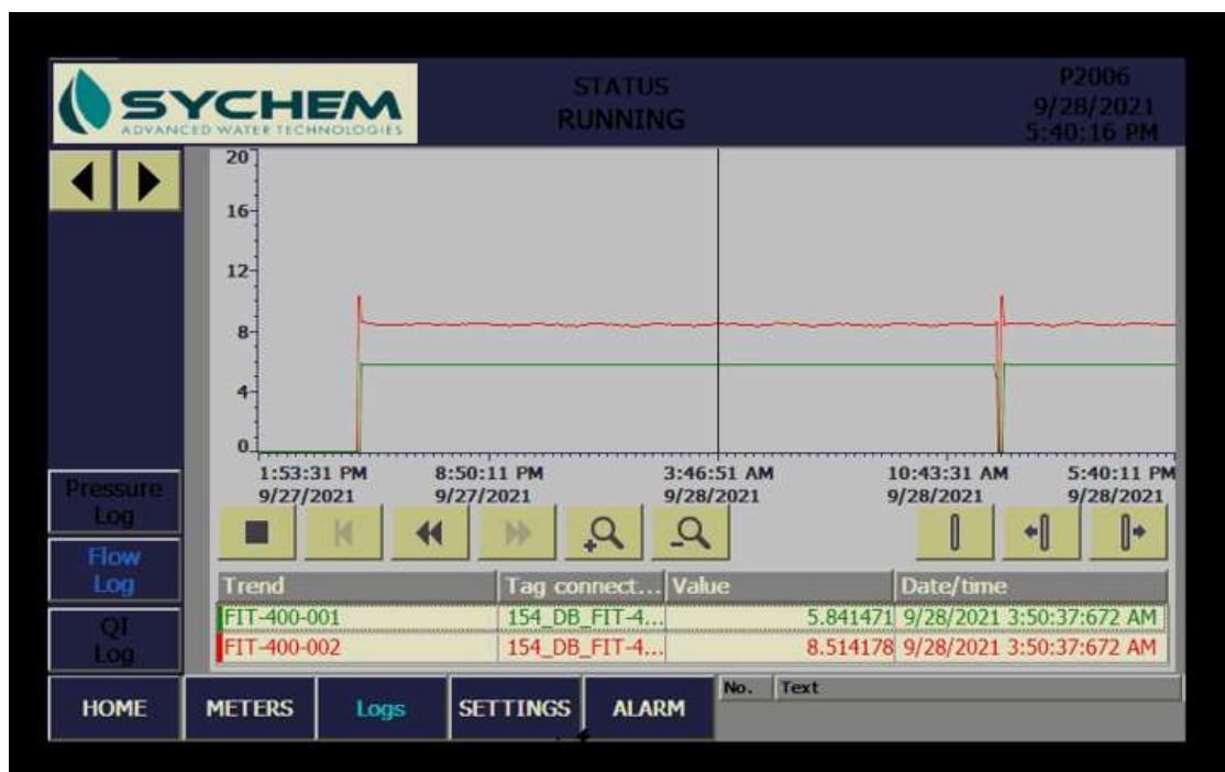
Εικόνα 5-34 Διάγραμμα μεταβολής της ογκομετρικής παροχής αφαλατωμένου νερού και αλμόλοιπου με τον χρόνο
