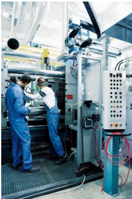
Σχήμα 2.4: Χύτευση υψηλής πίεσης ψυχρού θαλάμου Bühler SC/N 66 [14]
