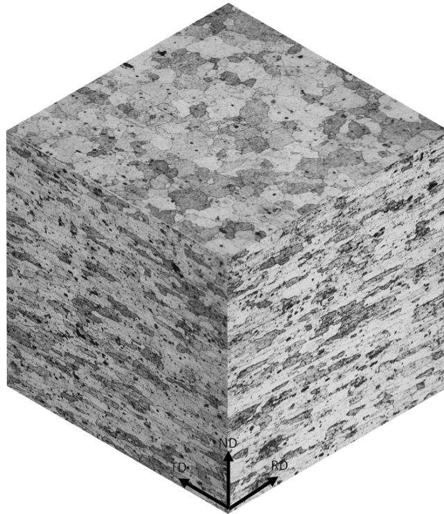
Σχήμα 3.2: Η μικροδομή του T6 στα 3 επίπεδα παρατήρησης (RD: διεύθυνση έλασης, TD: εγκάρσια στη διεύθυνση έλασης, ND: κάθετα στη διεύθυνση έλασης)
