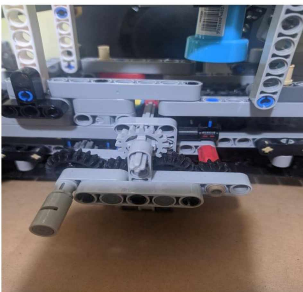
Εικόνα 22: Μηχανισμός με γρανάζια που δίνει κίνηση στον διπλό ιμάντα
