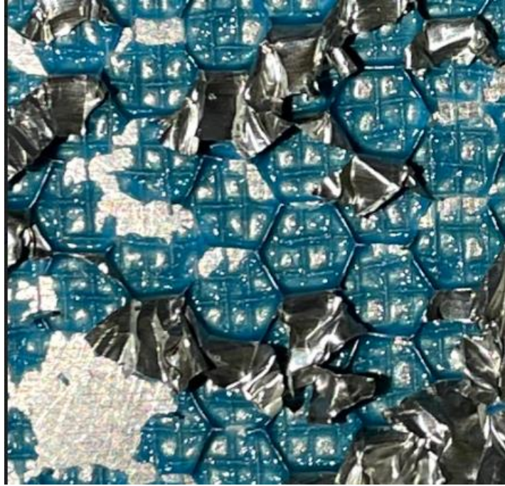
Εικόνα 4-4 Περιοχές με αποκόλληση κόλλας στο δοκίμιο 10
