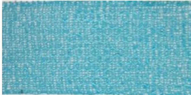
Εικόνα 3-10 Δομή κόλλας Hexbond 609 (Μορφολογία ινών)[25]
