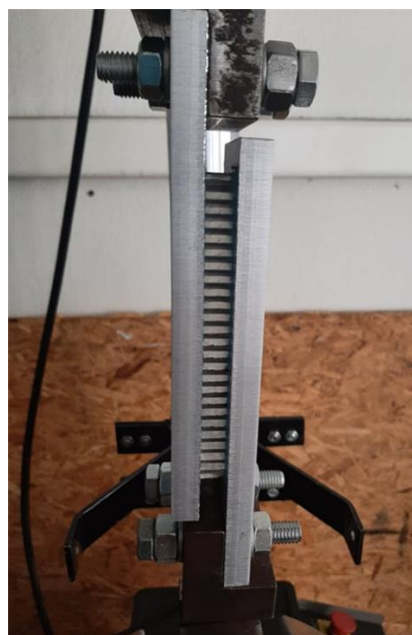
Εικόνα 3-22 Μηχανή εφελκυσμού-Θλίψης MTS 810 Material Test System(a), δοκίμιο πάνω στην μηχανή εφελκυσμού(β).
