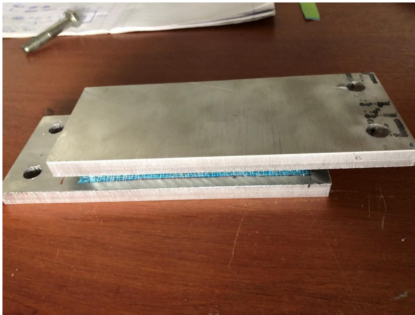
Εικόνα 3-19 Δύο πλάκες αλουμινίου και το honeycomb στο εσωτερικό τους
