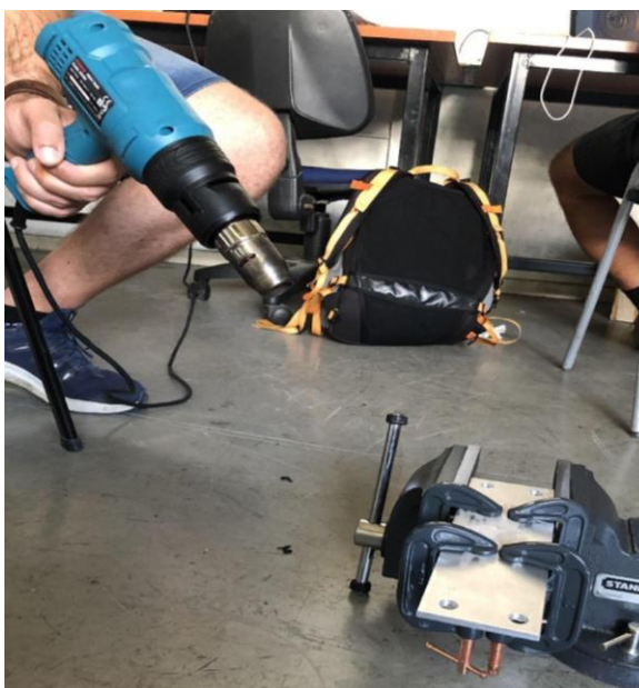
Εικόνα 3-21 Θέρμανσης της διάταξης με θερμοπίστολο για να υπολογιστεί η χαλάρωση των σφιγκτήρων
