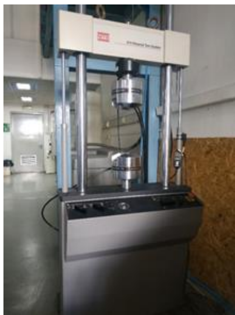
Εικόνα 3-22 Μηχανή εφελκυσμού-Θλίψης MTS 810 Material Test System(a), δοκίμιο πάνω στην μηχανή εφελκυσμού(β).
