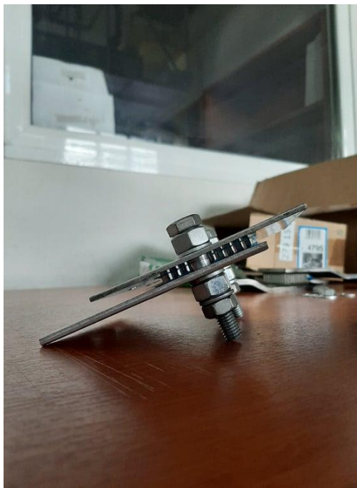
Εικόνα 3-12 Μέθοδος σύσφιξης της διάταξης με κοχλίες.
