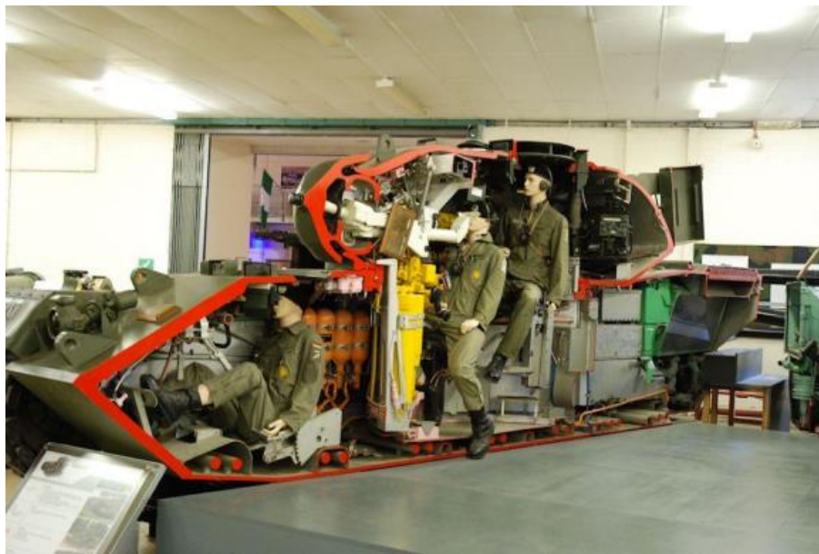
Εικόνα 2-10 Σκελετός άρματος τύπου Leopard I MBT με κυψελοειδή μορφή. [13]
