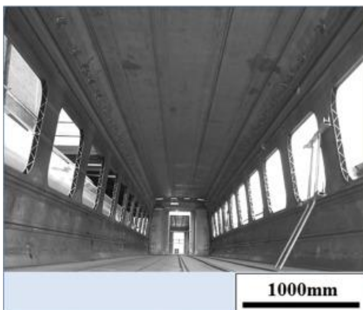
Εικόνα 2-8 Σώμα τρένου από υλικό τύπου Sandwich [11]
