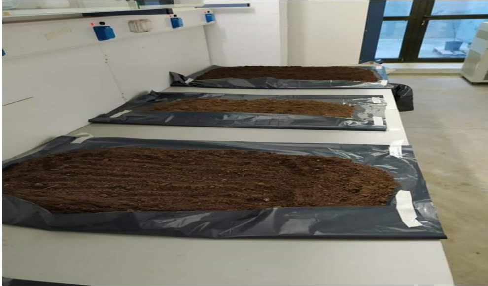
Εικόνα 6 : Εφαρμογή Albendazole στο έδαφος και προσαρμογή τις υγρασίες των εδαφών στο 40 % υδατοχωρητικότητας.
