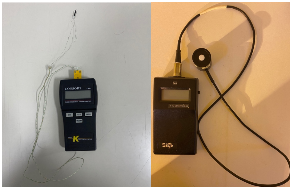
Εικόνα 2. Όργανα μέτρησης θερμοκρασίας (θερμοζεύγος, αριστερή φωτογραφία) και PAR (δεξιά φωτογραφία) των φυτών (προσωπικό αρχείο).
