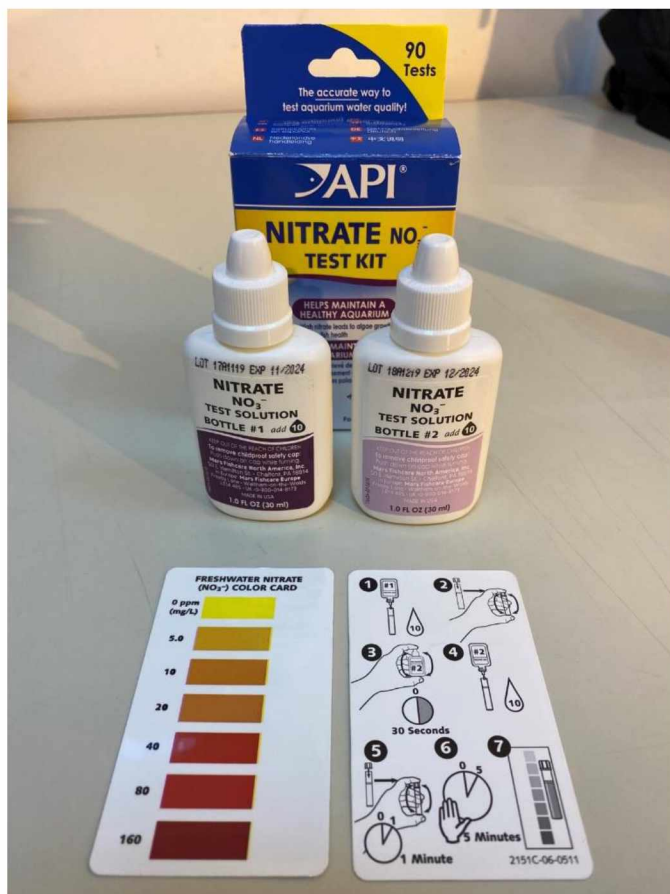
Εικόνα 8. Χρωματομετρικό κιτ μέτρησης νιτρικών (προσωπικό αρχείο)
