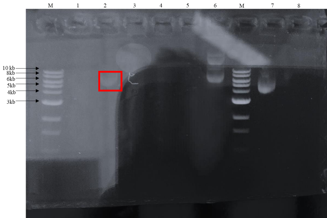
Εικόνα 14. Πηκτή αгарόζης 1% για διάκριση πλασμιδιακού DNA. M ως Marker (N0468S), 1: pETM-11 5:1 (2) , 2: pETM-11 5:1 (1) , 3: pETM-11 3:1 (2) , 4: pETM-11 3:1 (1) , 5: pETM-11 2:1 , 6: empty pETM-11 , 7: empty pET-28a , 8: pET-28a 5:1 .
