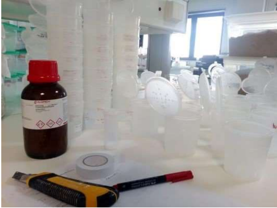
Εικόνα 3. Κυλινδρικά πλαστικά φιαλίδια (Rotilabo®-sample tins with snap-on lid, Carl Roth GmbH & Co. Kg, Karlsruhe, Germany) και polytetrafluoroethylene (Fluon, 60 wt% dispersion in water, Sigma-Aldrich Chemie GmbH, Steinheim, Germany).
