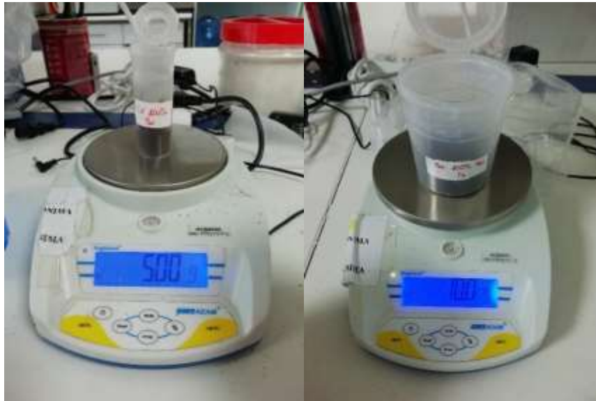
Εικόνα 5. Υπολογισμός των γραμμαρίων (g) στο ζυγό του υποστρώματος στο φιαλίδιο.
