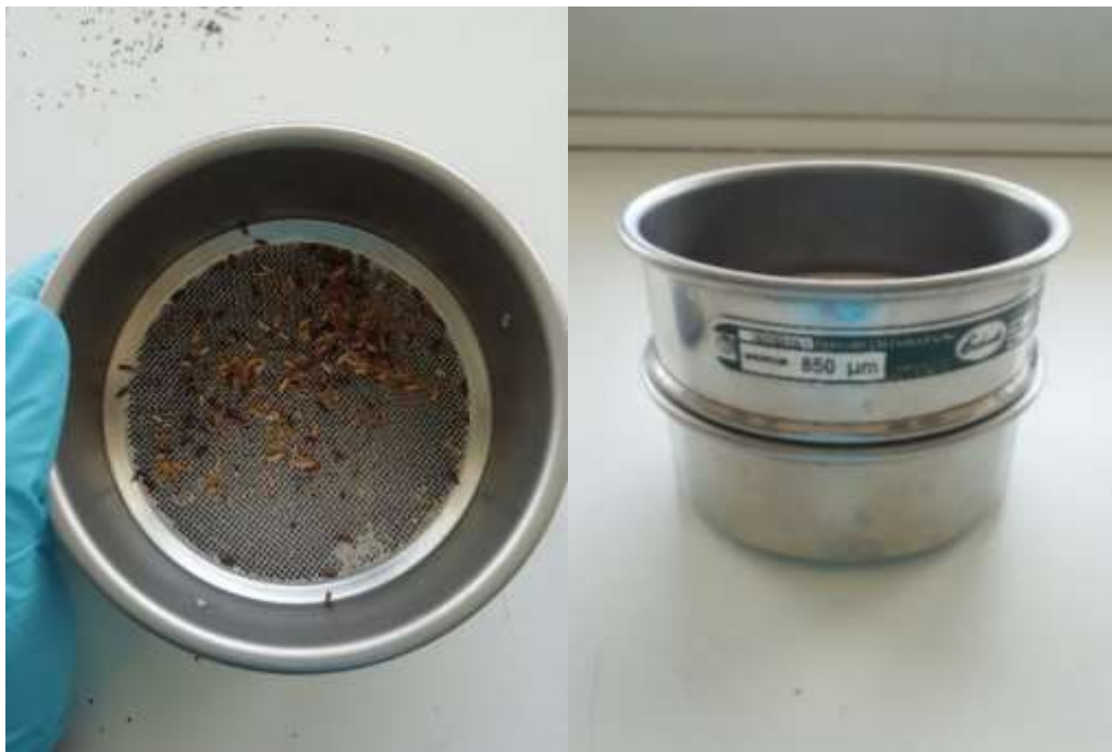
Εικόνα 11. Χρήση κόσκινου για διαχωρισμό του T. castaneum από το υπόστρωμα με σκοπό την καταμέτρηση του.
