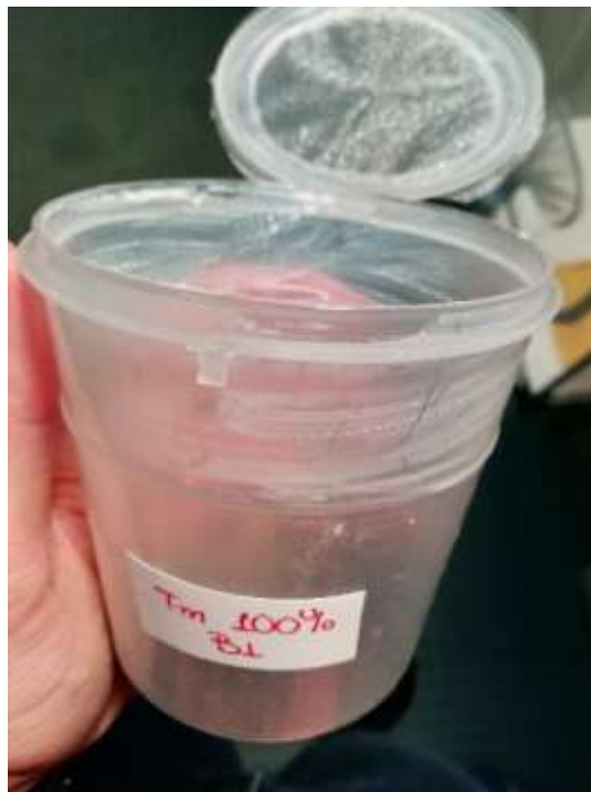
Εικόνα 4. Τελική μορφή φιαλιδίου έχοντας πραγματοποιηθεί άνοιγμα στο καπάκι και τοποθέτηση μουσελίνας, καθώς επικάλυψη με polytetrafluoroethylene (Fluon, 60 wt% dispersion in water, Sigma-Aldrich Chemie GmbH, Steinheim, Germany).
