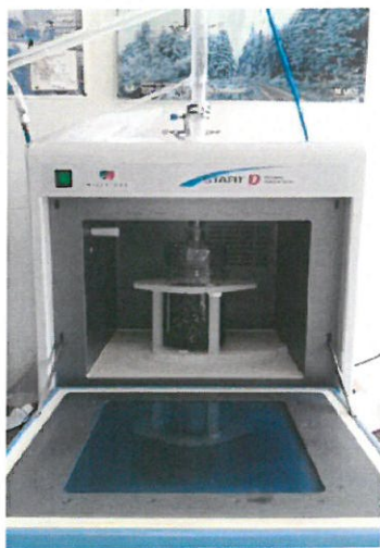
Εικόνα 4.7: Είσοδος και σταθεροποίηση του γυάλινου δοχείου στη συσκευή Milestone Start D Microwave Digestion System.
