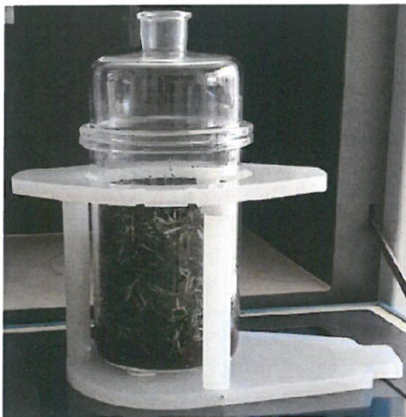
Εικόνα 4.6: Γυάλινο δοχείο της συσκευής Milestone Start D Microwave Digestion System με δείγμα φυτικού υλικού και απεσταγμένο νερό.
