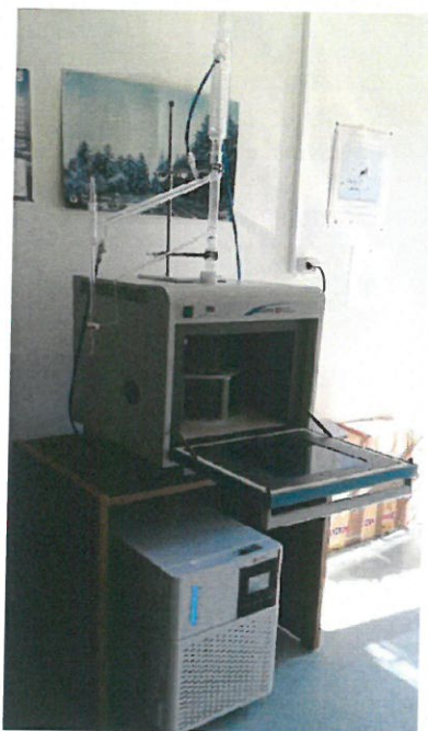
Εικόνα 4.8: Σύστημα εκχύλισης σε φούρνο χώνευσης με μικροκύματα χωρίς διαλύτες. Απεικόνιση της ψυκτικής μηχανής στο κάτω μέρος και της συσκευής εκχύλισης Milestone Start D Microwave Digestion System στο πάνω μέρος.
