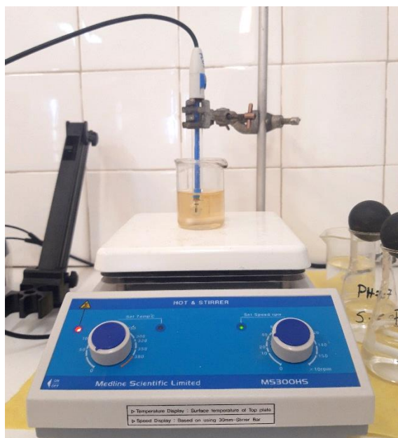
Εικόνα 12. Διαδικασία για τον προσδιορισμό του pH και της ολικής οξύτητας στους οίνους.
