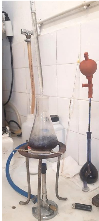
Εικόνα 11. Διαδικασία βρασμού του διαλύματος για τον προσδιορισμό των αναγόντων σακχάρων στους οίνους.
