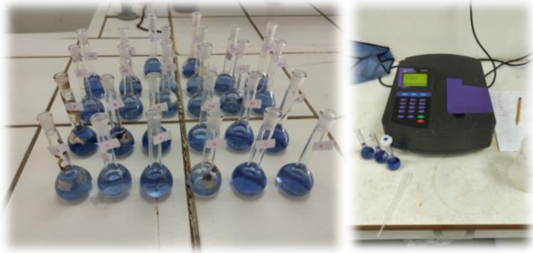
Εικόνα 6. Μέτρηση συγκέντρωσης φωσφόρου (P) στο φασματοφωτόμετρο, ύστερα από την ανάπτυξη του κυανού χρώματος στα διαλύματα.
