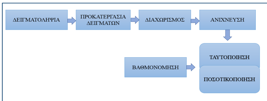
Εικόνα 16: Τα κύρια βήματα για ανάπτυξη μεθόδου HPLC.
