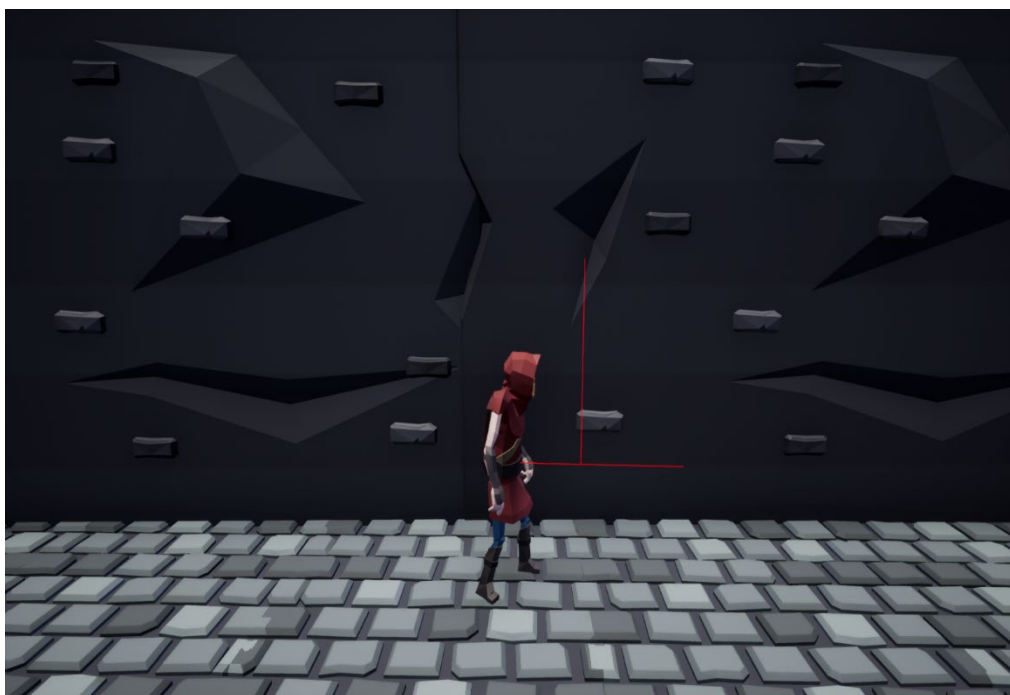
Εικόνα 8.4 Height και Forward line tracers για τον εντοπισμό του σημείου στο οποίο μπορεί να πιαστεί ο χαρακτήρας
