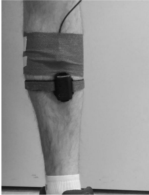
Φωτογραφία 1. Τοποθέτηση επιταχυνσιόμετρου.
