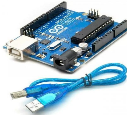
Εικόνα 4.8 Arduino uno με Usb cable
