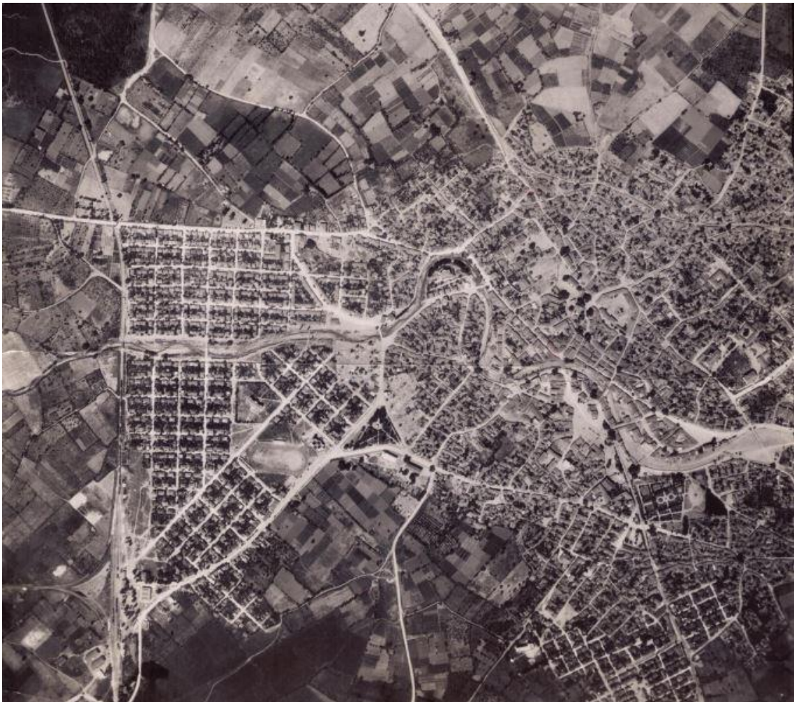
Εικόνα 1: Οργανωμένη ρυμοτομία σε Ιπποδάμειο σύστημα στις νότιες και νοτιοδυτικές περιοχές της Κομοτηνής, 1922-25
