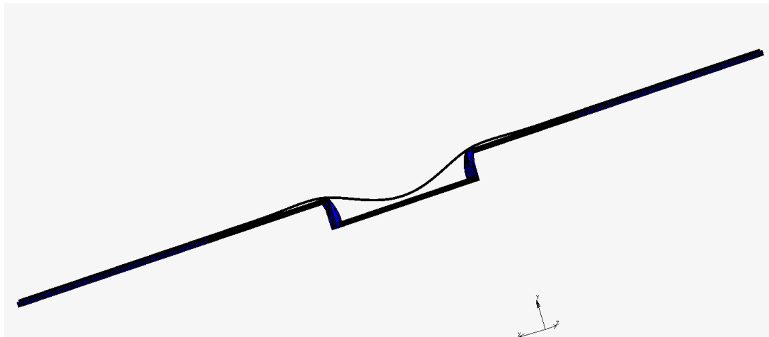
Εικόνα 4.34: Αναπαράσταση ελεύθερου τμήματος αγωγού
