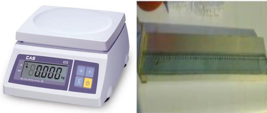
Εικόνα 8: (α) ζυγός ακριβείας για τη μέτρηση του ολικού βάρους σε gr , (β) ιχθυόμετρο για τη μέτρηση του ολικού μήκους (Πηγή: προσωπικό αρχείο)
