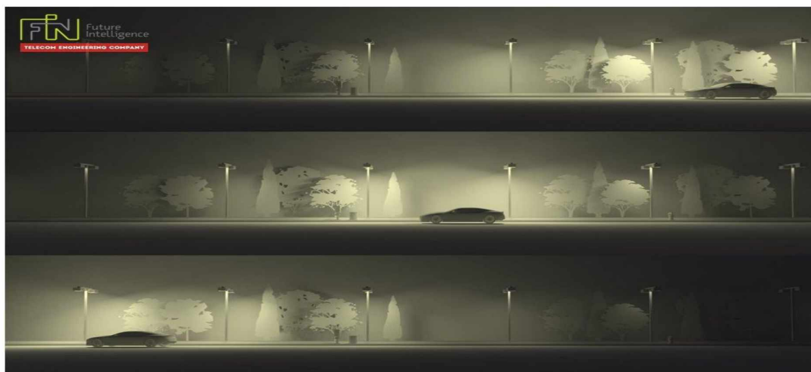
Εικόνα 56:Σύστημα έξυπνου φωτισμού
