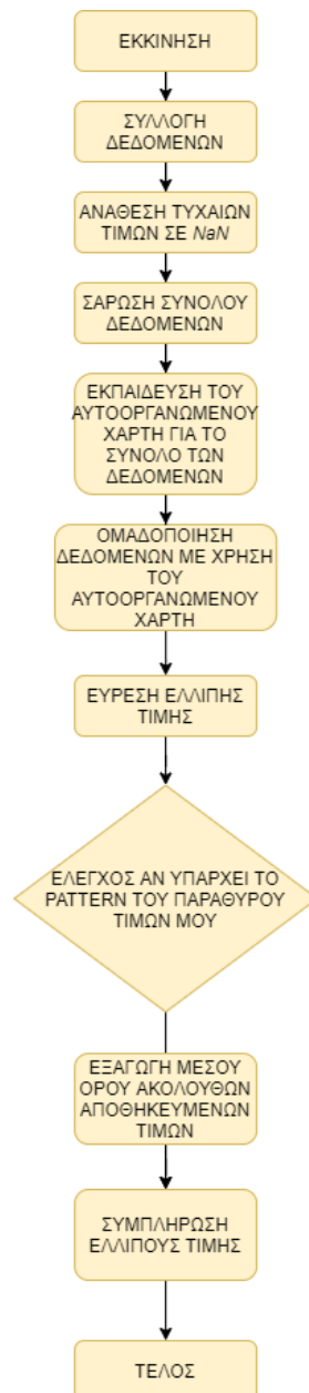
Σχήμα 2.36: Διάγραμμα ροής μεθοδολογίας συμπλήρωσης με χρήση αυτοοργανωμένου χάρτη (Self-Organizing Map)
