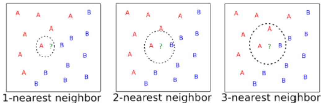
Σχήμα 2.12: Παραδείγματα 1 ου -2 ου -3 ου κοντινότερου γείτονα για ένα testδεδομένο [13]
