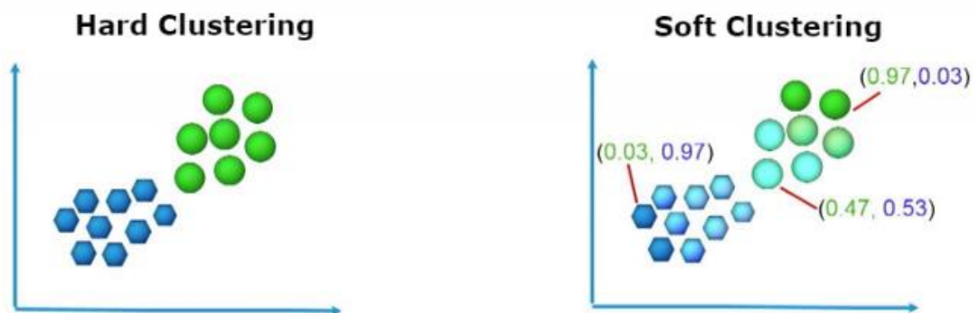
Σχήμα 2.31: Σύγκριση hard clustering και soft clustering [29]
