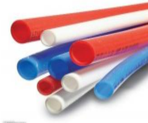
Εικόνα 2-22 Έγχρωμοι σωλήνες PEX για διαχωρισμό θερμού (κόκκινοι σωλήνες) και ψυχρού (μπλε σωλήνες) ρεύματος, και λευκοί σωλήνες σε περίπτωση που δεν επιθυμούμε σωλήνες με διαφορετικά χρώματα
