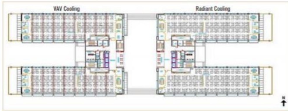
Εικόνα 2-36 Κάτοψη κτιρίου SDB-1 Αριστερά: σύστημα ψύξης VAV, Δεξιά: υδραυλικό σύστημα ψύξης με ακτινοβολία (Guruprakash Sastry et al., 2014)
