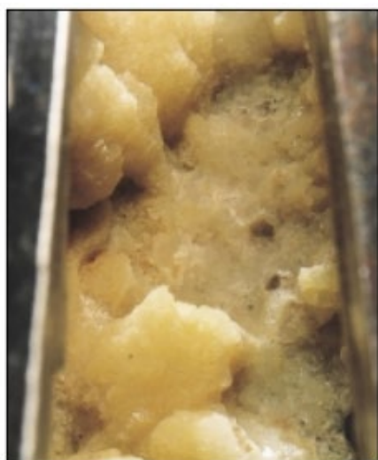
Σχήμα 3.7 - Αφαίρεση \text{CaCO}_3 με water jetting [4]
