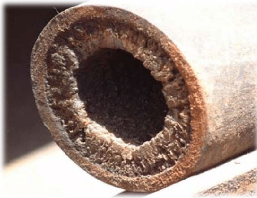
Σχήμα 2.4 - Επικάθιση \text{SrSO}_4 [πηγή: Water Chemistry in Oil and Gas Operations: Scale Properties and Composition]
