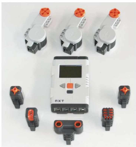
Εικόνα 5. Υλικό του Lego Mindstorms NXT: πέντε αισθητήρες (φωτός, ήχου, υπερήχων, αφής), τρεις σερβοκινητήρες και το ρομπότ (Behrens, et al., 2010)
