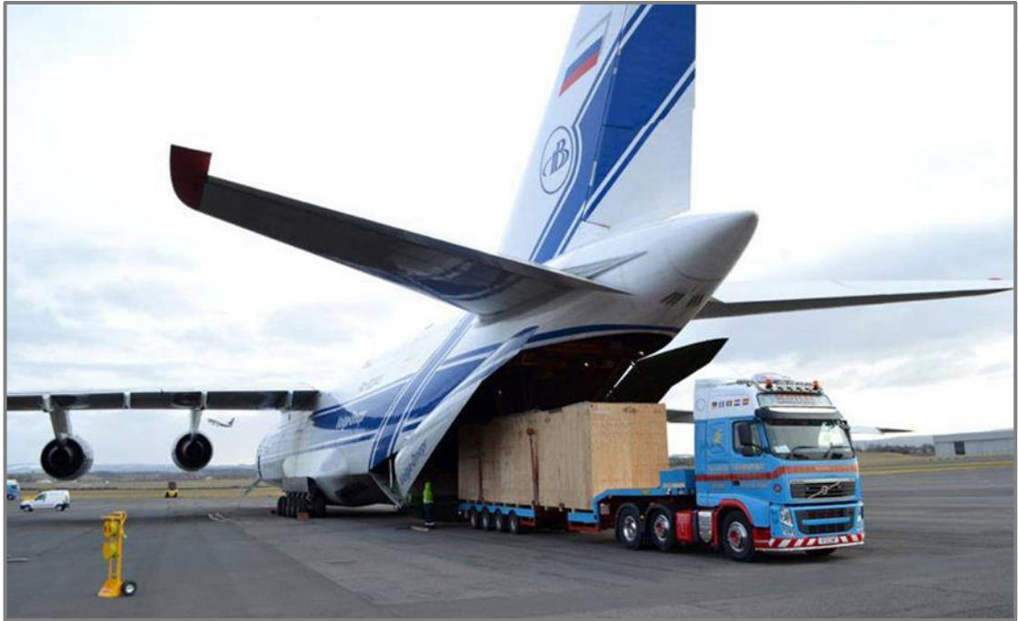
Σχήμα 4.2: Διαδικασία μεταφοράς βαρέων φορτίων μέσω αεροπλάνου τύπου Antonov An (Πηγή: areal-tur.ru).
