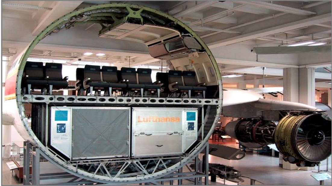
Σχήμα 4.1: Διατομή αεροσκάφους Airbus A300-Δείγμα εμπορευματοκιβωτίων στο κάτω μέρος του καταστρώματος (Πηγή: Asiir, 2002).
