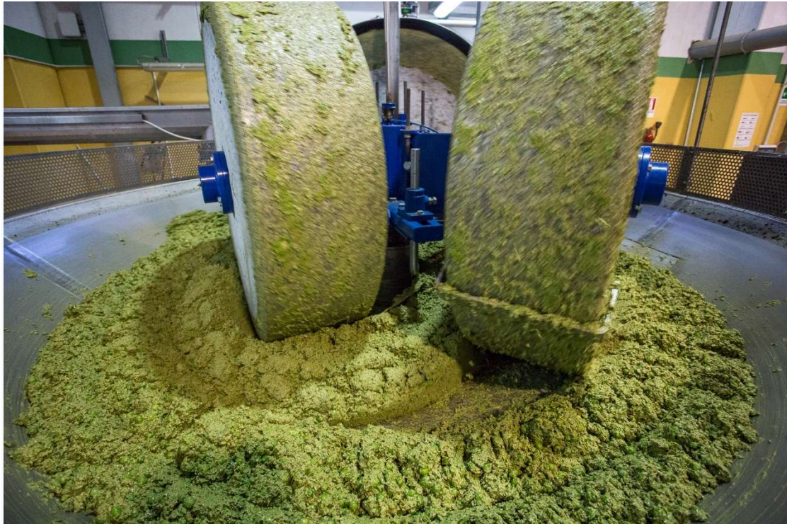
Εικόνα 2. Μετατροπή ελιών σε πάστα
