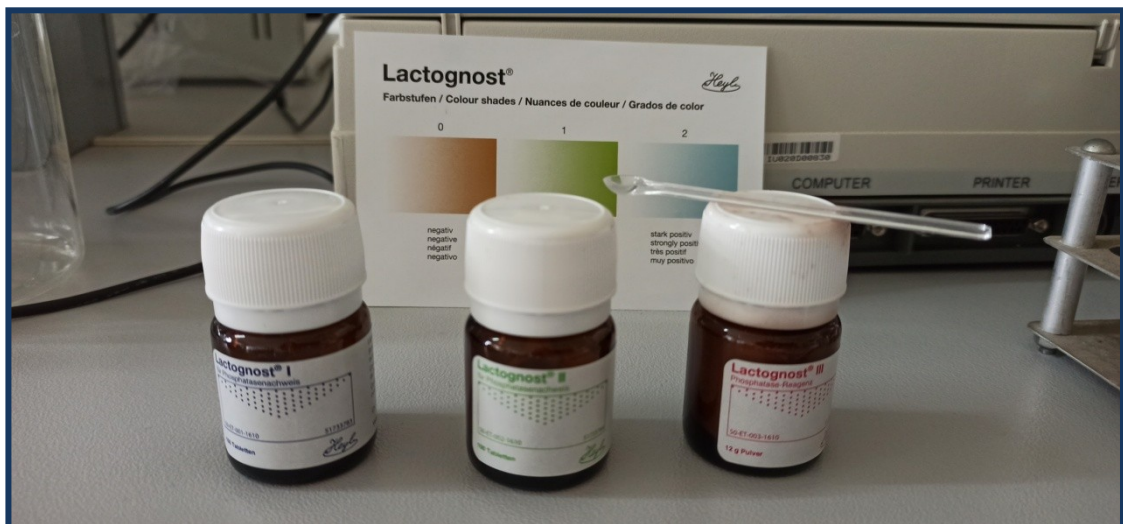
Εικόνα 23. Ταμπλέτες lactognost I, lactognost II και σκόνη lactognost III. Στο κουτί περιγράφονται οι πιθανές χρώσεις των δειγμάτων γάλακτος, ανάλογα με το βαθμό παστερίωσής τους.
