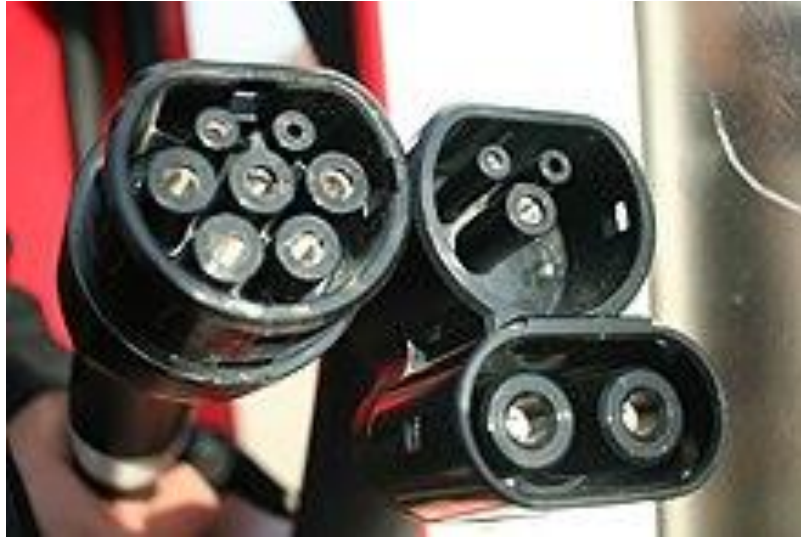
Εικόνα 3.9: Βύσματα που χρησιμοποιεί η Tesla
