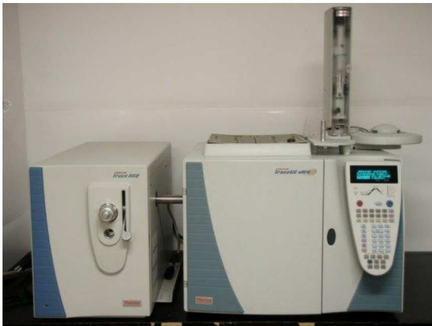
Εικόνα 8.2: Σύστημα A Finnigan Trace GC Ultra/Polaris Quadrupole Ion Trap GC/ MS system.
