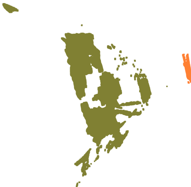
Εικόνα 2-2 Τα νέφη σημείων για δύο ίδια αντικείμενα. Με πράσινο χρώμα της RealSense και με πορτοκαλί του Laser όπως φαίνεται με την μέθοδο visualization.draw_geometries από την βιβλιοθήκη της Open3d.
