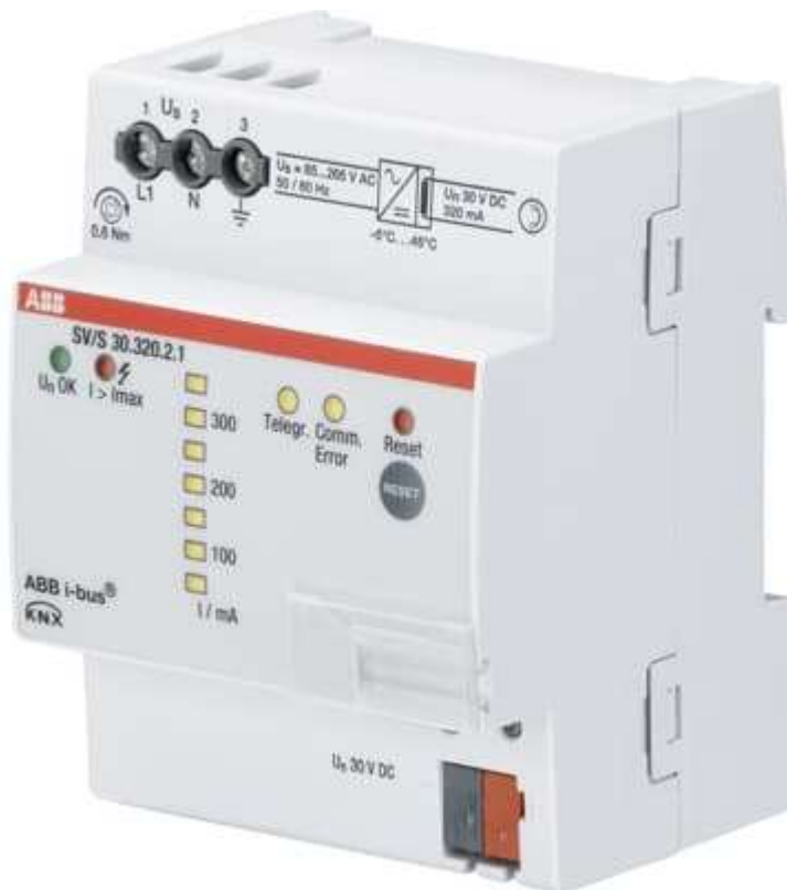
Εικόνα 4. Τροφοδοτικό με πηνίο της ABB( Οι επαφές 1,2,3 είναι για φάση ουδέτερο και γείωση αντίστοιχα και μία έξοδο DC στα 30V και 320mA) Με led ένδειξης κατάσταση λειτουργίας, σφαλμάτων και κουμπί reset
