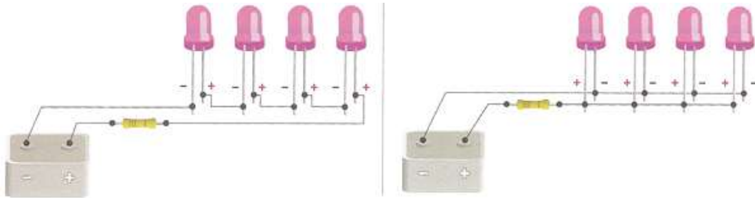
Εικόνα 14 Σύνδεση σε σειρά (Αριστερά) παράλληλα(Δεξιά)
