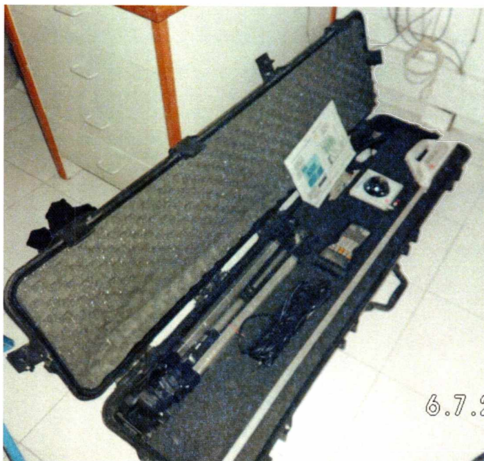
Εικόνα 4 :Το σύστημα Sun Scan canopy analysis για τη μέτρηση του L.A.I.
