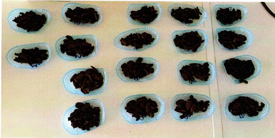
Εικόνα 3.4 Τεμάχια σάρκας ελιάς που ξηράνθηκαν σε ξηραντήρα για υπολογισμό του ξηρού βάρους σάρκας
