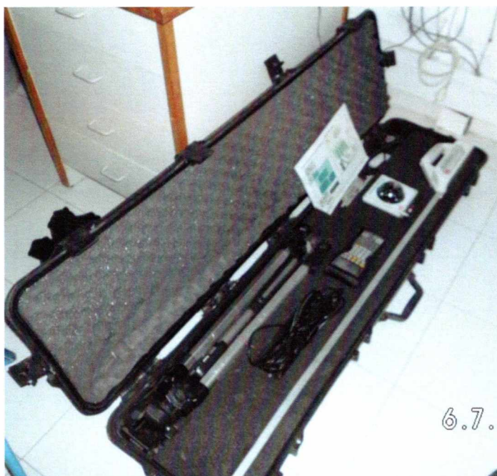
Εικόνα 4.6: Σύστημα μέτρησης του Δείκτη Φυλλικής Επιφάνειας (L.A.I.).
