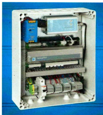
Σχήμα 1.3 RTU συστήματος SCADA
