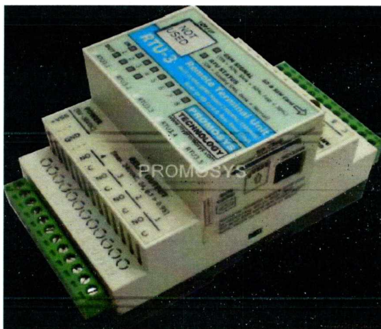
Σχήμα 1.3 RTU συστήματος SCADA
