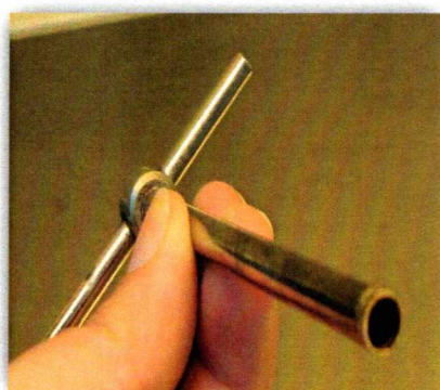
Εικόνα 35: Φελλοτρυπητής - cork borer (αριστερά) και κυκλική ανάπτυξη μυκηλίου, στην περιφέρεια του οποίου εμφανίζονται οι αποσπώμενοι δίσκοι μυκηλίου (5mm/δίσκος μυκηλίου) (δεξιά) (Πηγή: Εργαστήριο Φυτοπαθολογίας)
