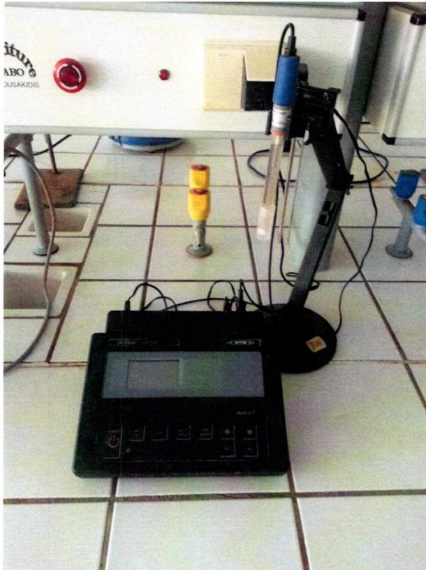
Εικόνα 1. Το ηλεκτρικό πεχάμετρο του Εργαστηρίου Εδαφολογίας του Πανεπιστημίου Θεσσαλίας.
