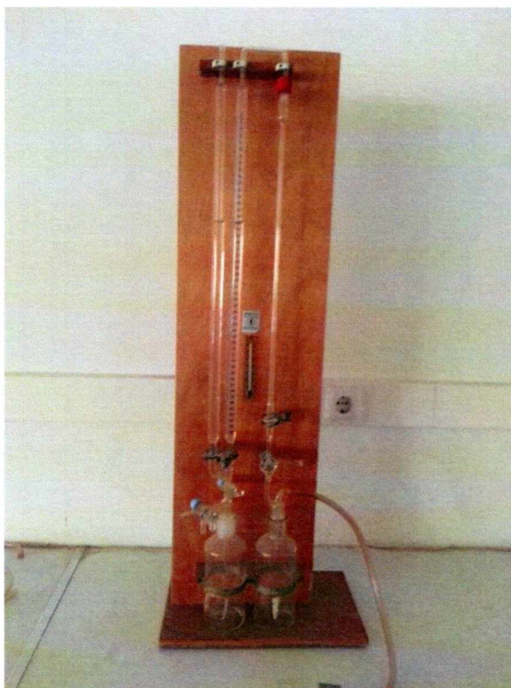
Εικόνα 3. Το ασβεστόμετρο του Εργαστηρίου Εδαφολογίας του Πανεπιστημίου Θεσσαλίας.
