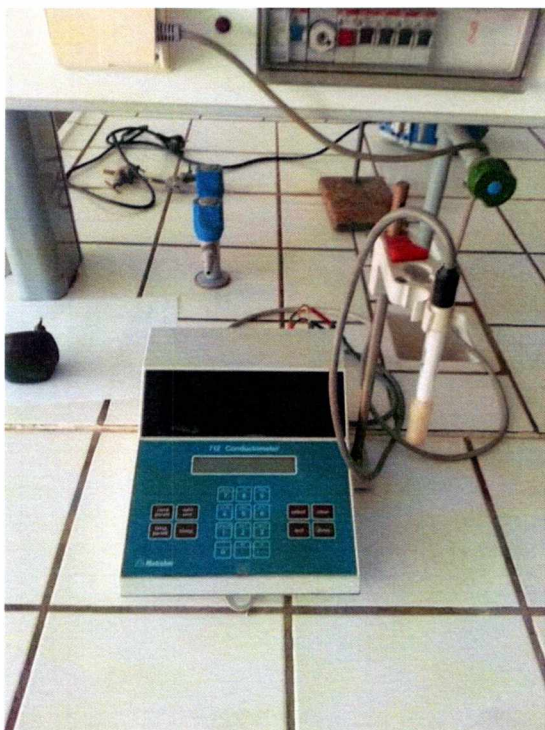
Εικόνα 2. Το όργανο μέτρησης ηλεκτρικής αγωγιμότητας (αγωγιμόμετρο) του Εργαστηρίου Εδαφολογίας του Πανεπιστημίου Θεσσαλίας.
