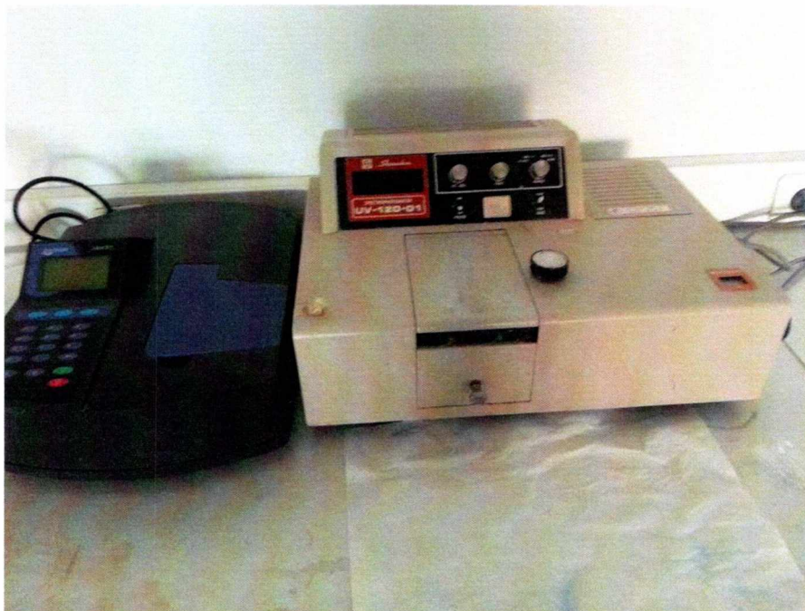
Εικόνα 4. Το φασματοφωτόμετρο του Εργαστηρίου Εδαφολογίας του Πανεπιστημίου Θεσσαλίας.
