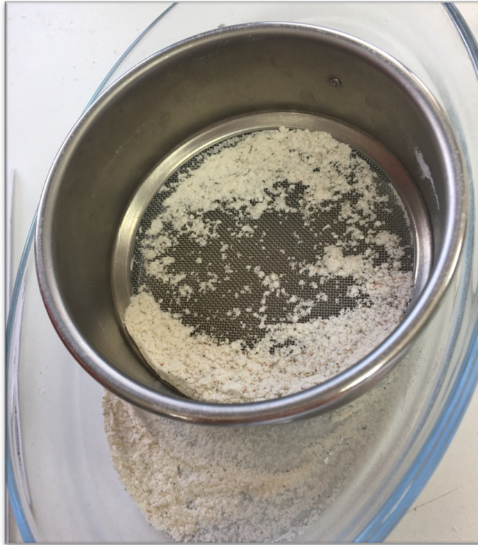
Εικόνα 21 Κόσκινο των 600μm το οποίο συγκρατούσε τα αυγά του Tenebrio molitor .
