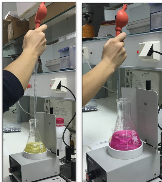
Εικόνα 14 Τιτλοδότηση του διαλύματος βορικού αμμωνίου με αραιό διάλυμα υδροχλωρικού οξέος (0,1N) υπό καθεστώς συνεχούς κίνησης.
