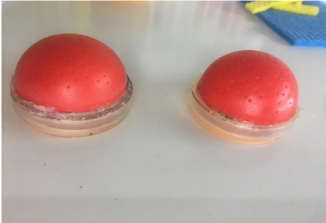
Εικόνα 2.7: Κοίλα διάτρητα πλαστικά ημισφαίρια κόκκινου χρώματος (dome) τοποθετημένα πάνω στα τριβλία.
