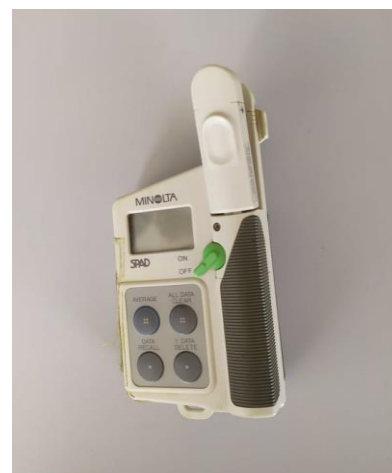
Εικόνα 4: Συσκευή μέτρησης συγκέντρωσης χλωροφύλλης SPAD-S02, CCM 200, Opti-Science, NH, USA
