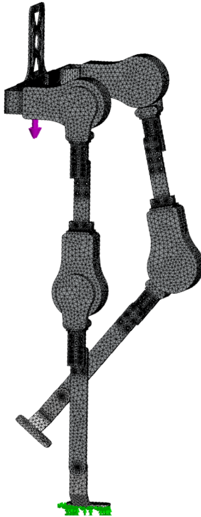
Σχήμα 4.5: Το αρχικό πλέγμα που σχηματίστηκε με την μέθοδο «curvature-based mesh»
