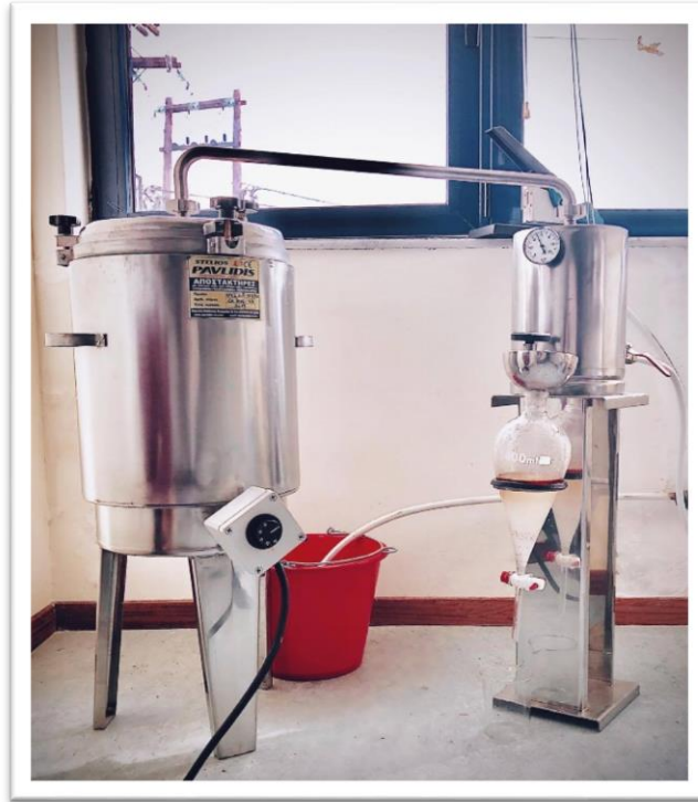
Εικόνα 5. Ανοξειδωτος αποστακτήρας υδρο-ατμοαπόσταξης αιθερίων ελαίων
