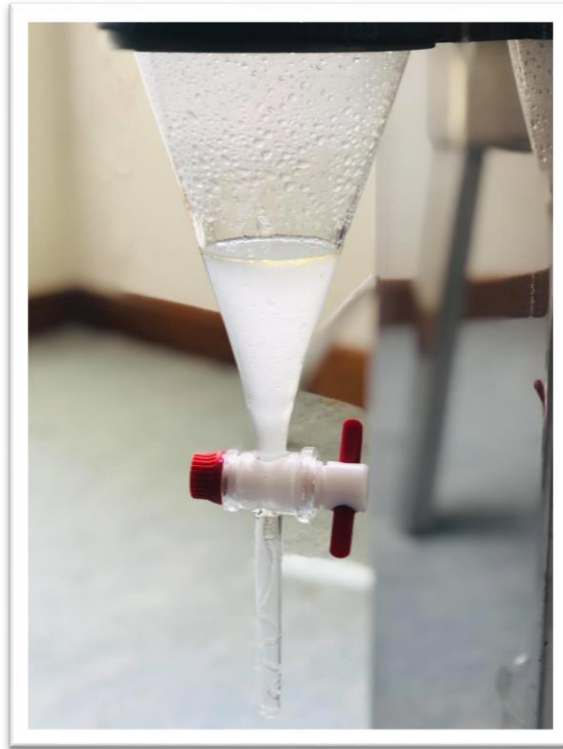
Εικόνα 6. Παραλαβή αιθερίου ελαίου γλυκάνισου με υδρο-ατμοαπόσταξη
