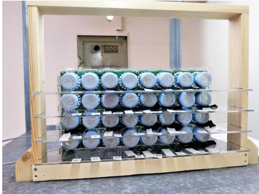
Εικόνα 6.7: Το LAM25system με προσαρμοσμένη ξύλινη κατασκευή/ πλατφόρμα για την καταμέτρηση των αυγών.
