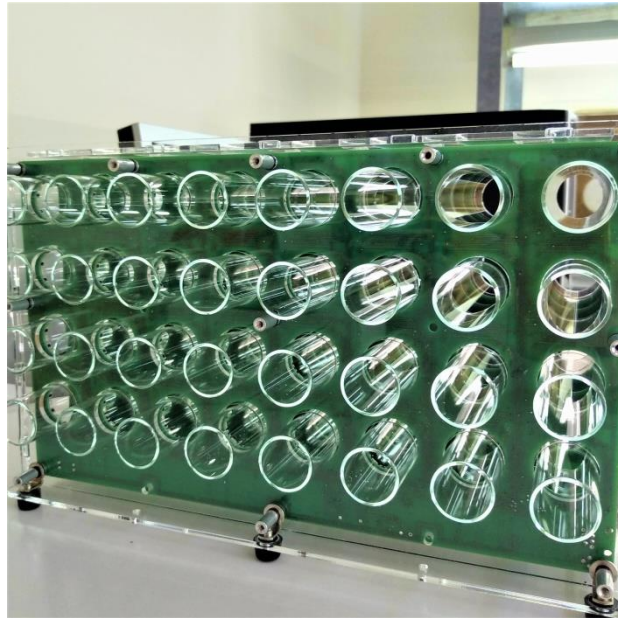
Εικόνα 6.1: Σύστημα ημερήσιας καταγραφής δραστηριότητας LAM25system (Trikinetics) με τους γυάλινους σωλήνες τοποθετημένους στα 32 σημεία εισόδου.
