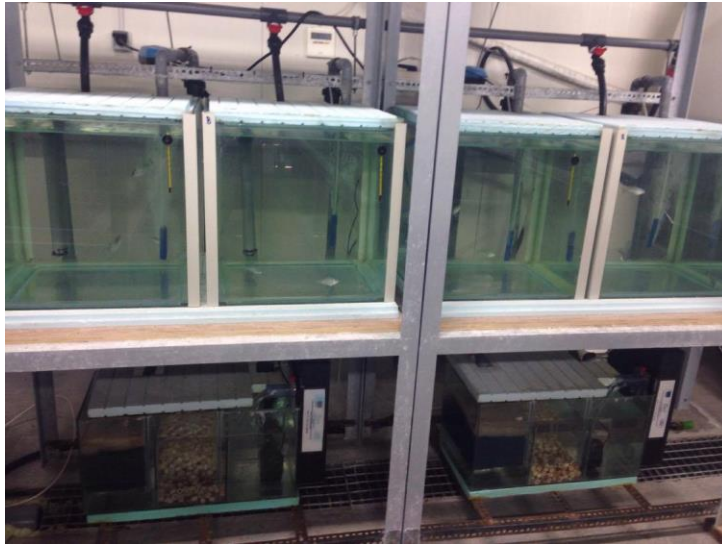
Εικόνα 2.1: Διάταξη δεξαμενών και απεικόνιση του συστήματος φιλτραρίσματος-αποστείρωσης. Πηγή: προσωπικό αρχείο
