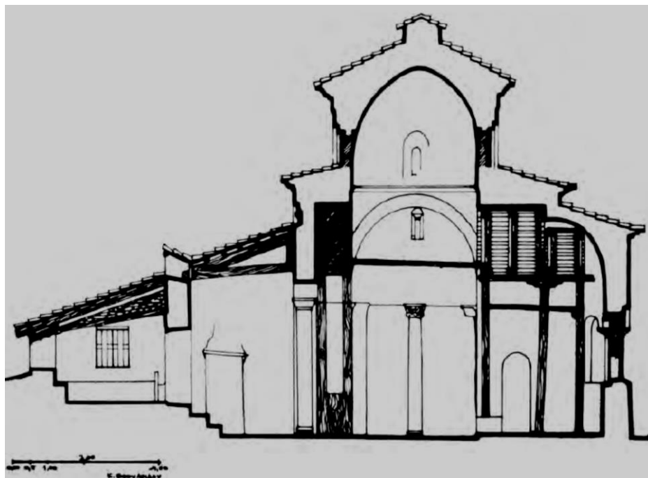
Εικ. 6. Κουντουριώτισσα, ναός Παναγίας, τομή πριν από τις εργασίες, με τις εσωτερικές υποστυλώσεις κατά χώραν (πηγή: Λαζαρίδης 1973-1974, σχέδ. 19)
