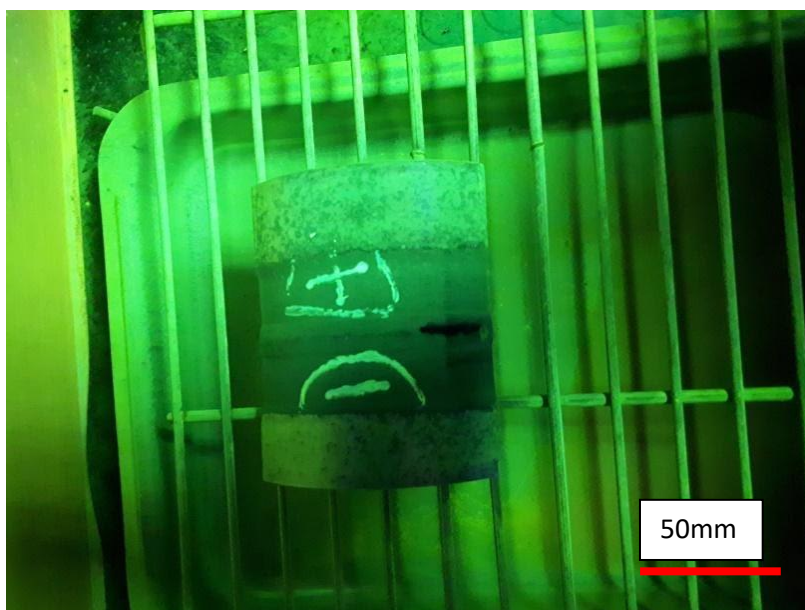
Εικόνα 20: Φθορίζοντα διεσδυτικά υγρά στο δοκίμιο A.
