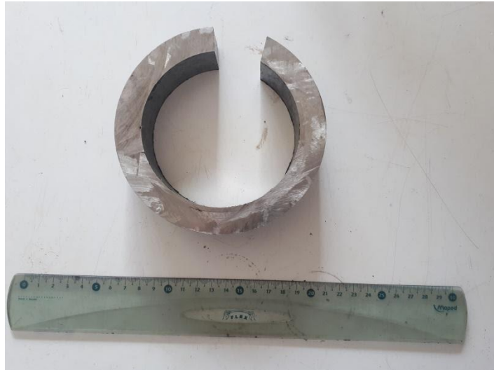
Εικόνα 28: Δοκίμιο Γ βαθμονόμησης από το υλικό H39WM.
