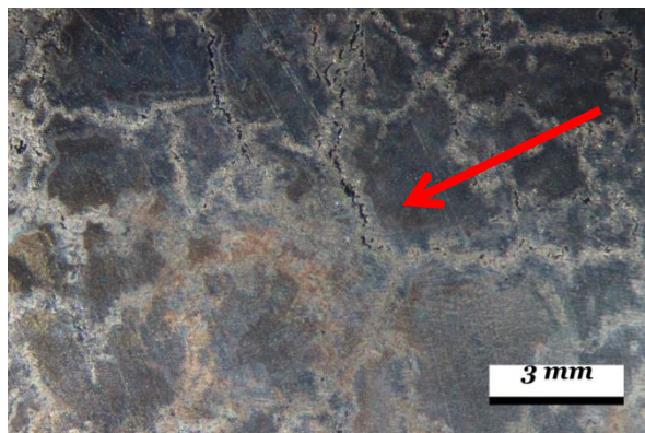
Εικόνα 50: Ανάπτυξη μακρορωγμών σε όλο το πάχος του δοκιμίου.
