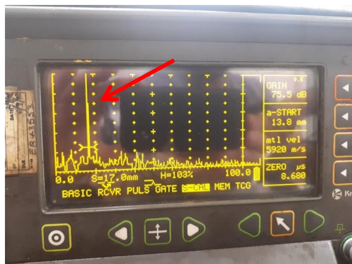
Εικόνα 29: Βαθμονόμηση της συσκευής με τον σωλήνα H39WM.
