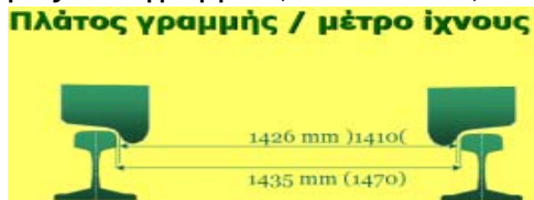
Εικόνα 3.5 - Απόσταση σιδηροτροχιών (Πηγή Συστήματα σταθερής τροχιάς)
