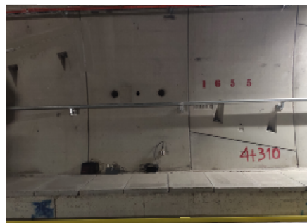
Εικόνα 5.2 - Υπόγεια μέτρηση ταχύτητας δόνησης
