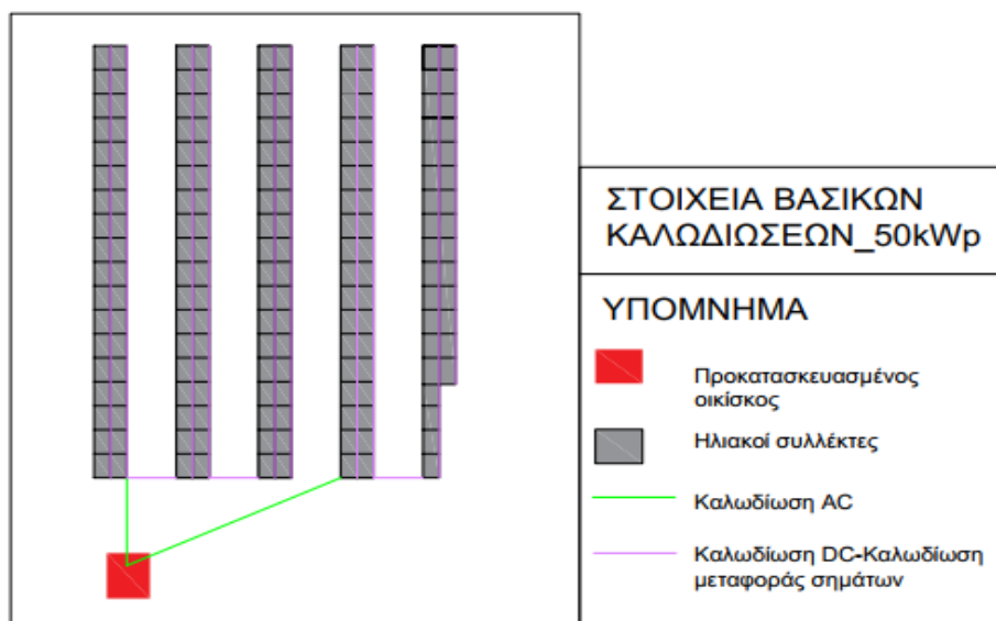
Εικόνα 23: Βασικές καλωδιώσεις εγκατάστασης ισχύος 50kWp
