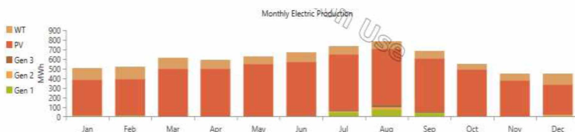
Διάγραμμα 8.26: Απεικόνιση της συνεισφοράς των συστατικών του υβριδικού συστήματος στη συνολική παραγωγή ηλεκτρικής ενέργειας για κάθε μήνα ενός έτους [Homer]
