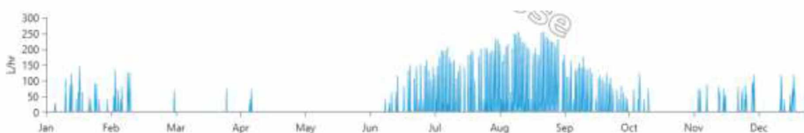
Διάγραμμα 8.25: Απεικόνιση της κατανάλωσης πετρελαίου καθ' όλη τη διάρκεια ενός έτους [Homer]
