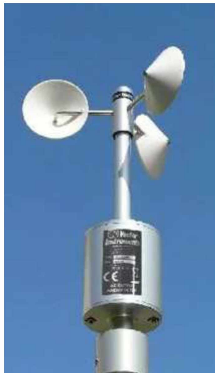
Εικόνα 4.5: Ανεμόμετρο (μετρά την ένταση του ανέμου)
